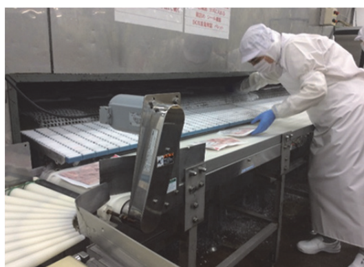
写真3 トンネルフリーザー
